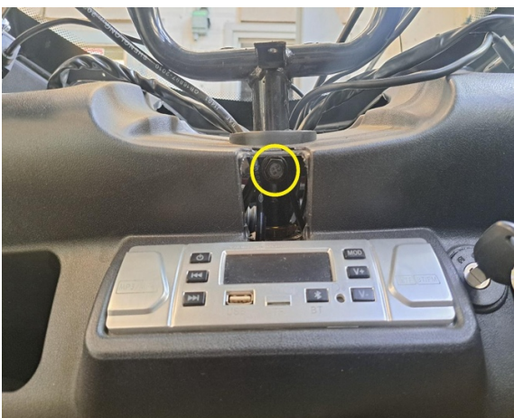
Irrota ohjaustangon kiinnityspultti, jolla on vastamutteri (hylsy 14 mm, kiintoavain 14 mm).
