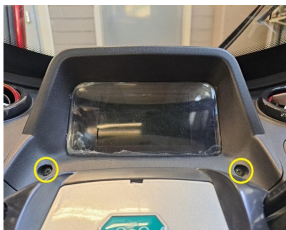
Irrota mittariston kiinnitysruuvit. (ristipäämeisseli ph2).
