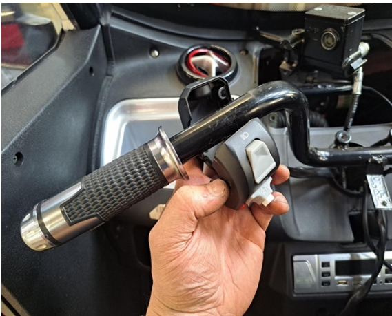
Siirrä ohjaustangon vasemmanpuoleinen katkaisia paketti sivuun.
