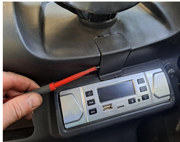
Kampea ohjaustangon kiinnityspultin kanta (talttameisseli).
