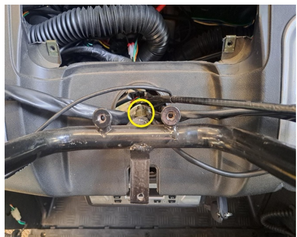
Irrota ohjaustangon kiinnityspultti, jolla on vastamutteri (hylsy 14 mm, kiintoavain 14 mm).
