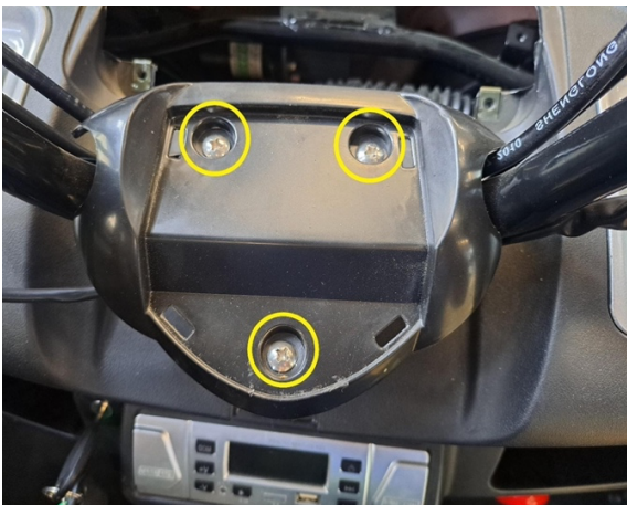
Irrota ohjaustangon suojuksen pidikkeen kiinnitysruuvit (ristipäämeisseli ph2).
