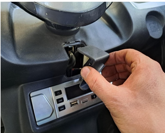
Ota ohjaustangon kiinnityspultin kansi pois.
