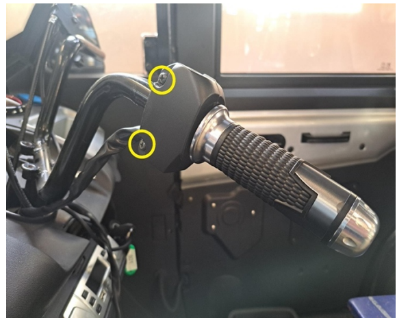
Irrota ohjaustangon vasemmanpuoleinen katkaisia pakettin kiinnitysruuvit (ristipäämeisseli ph2).
